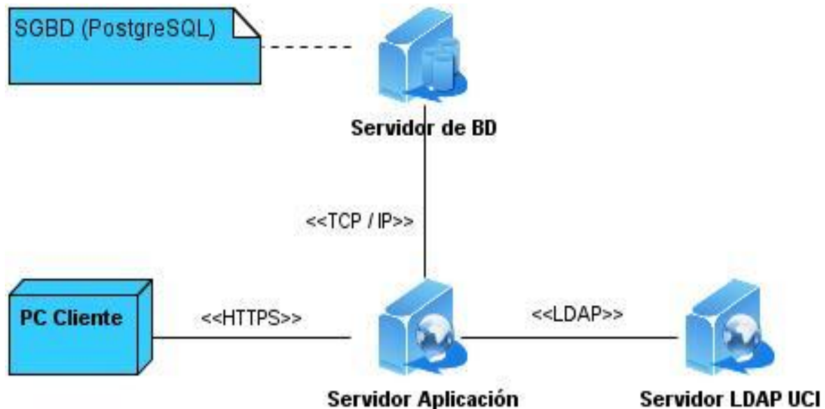
Figura 34: Diagrama de despliegue del sistema
