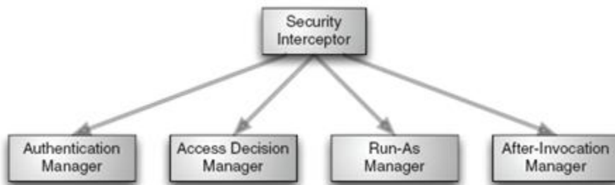
Figura 3: Elementos fundamentales de Spring Security
