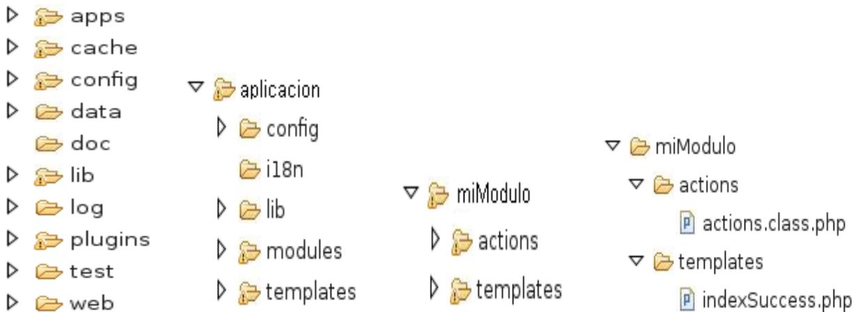
**Fig. 11 Estructura física real definida por el framework Symfony**
