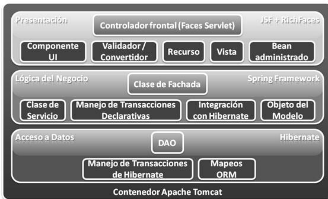
Figura 1.1: Patrón arquitectónico de 3 capas seleccionado para ser usado en el proyecto CICPC y representación de los frameworks de desarrollo dentro del mismo.
