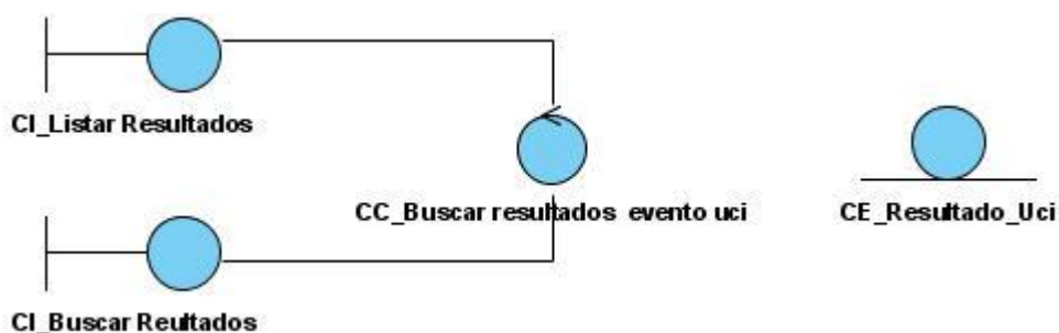
Figura 3. 3 Diagrama de clases del análisis del caso de uso: Buscar Resultados Eventos UCI.
