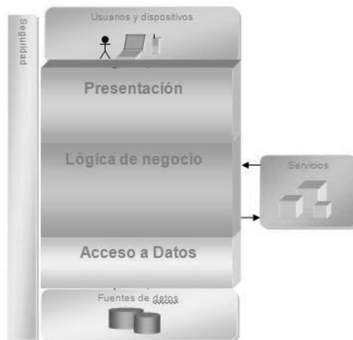
Figura 1: Arquitectura en 3 capas.
