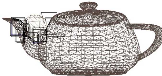
Fig. 2.20 Intersección entre una esfera y un AABB tree.
