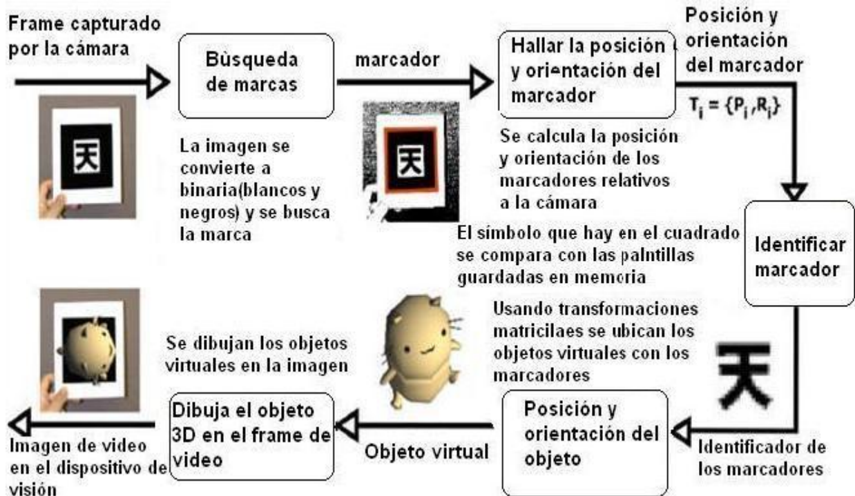
Figura 24 Pasos del algoritmo de posicionamiento en ARToolkit
