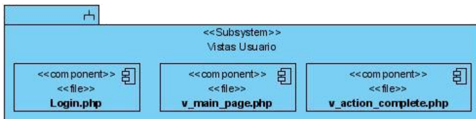
FIGURA 11. SUBSISTEMA VISTAS DE USUARIO.
