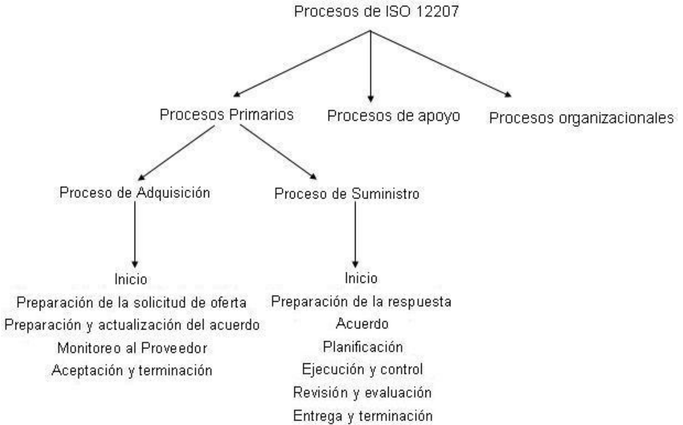
Figura 1: Representación de los procesos de la Gestión de Acuerdos con Proveedores dentro de la norma ISO 12207.
