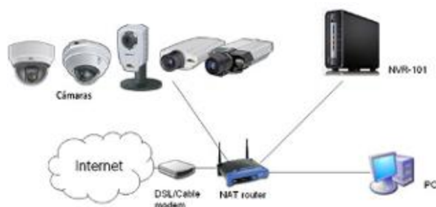
Fig. 3 Esquema de un sistema que incluye un NVR.
