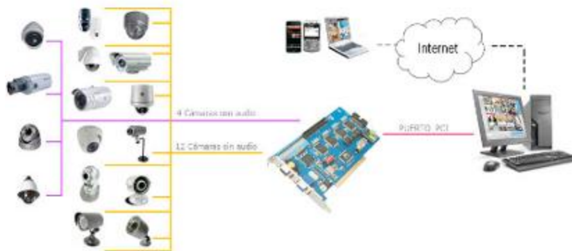
Fig. 2 Esquema de un sistema que incluye un DVR basado en PC.
