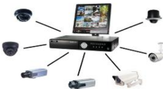
Fig. 1 Esquema de un sistema que incluye un DVR Non-PC based.
