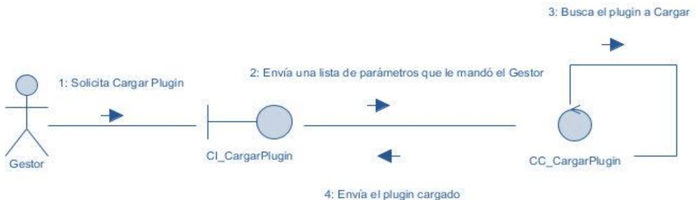
**Figura 12:** Diagrama de Colaboración para el CU Cargar Video-Sensor para iniciar procesamiento.
