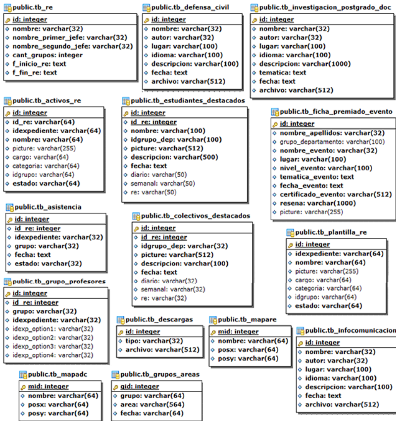
Figura 4. Estructura de las 15 tablas añadidas a la base de datos de Drupal.
