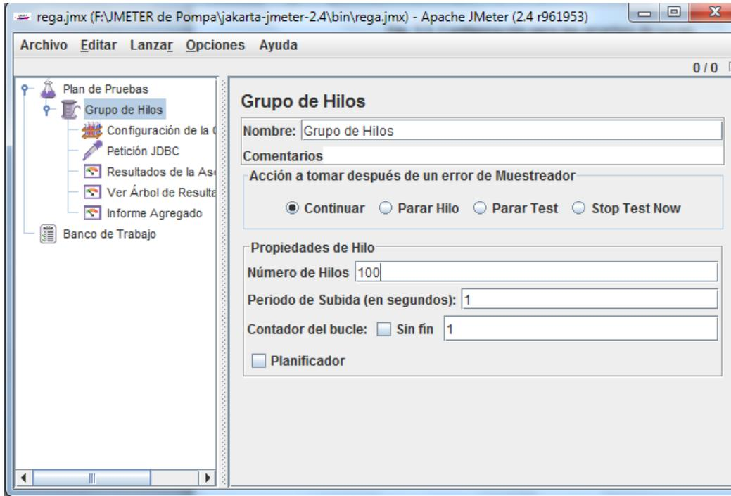
**Fig. 3.4 Configuración de Grupos de Hilos.**
