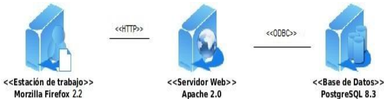
Figura 8: Modelo de despliegue
