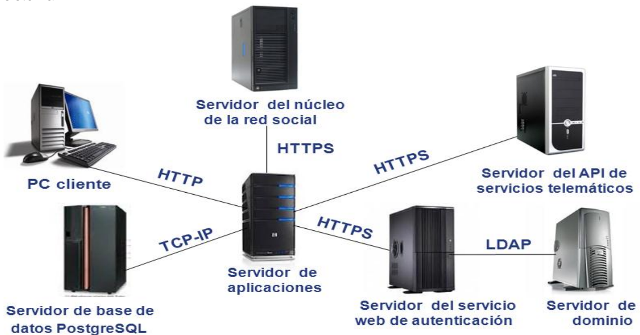
Figura 6 Diagrama de despliegue del sistema.
