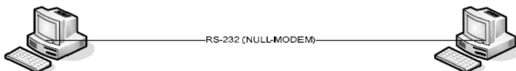
FIGURA 6: Conexión directa mediante cable NULL-MODEM
