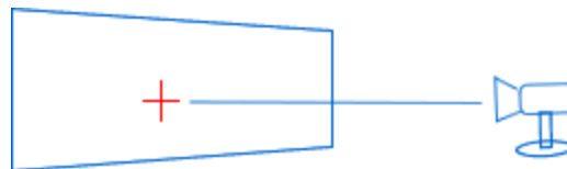
Fig.7: Representación de la intersección entre el eje óptico de la cámara y el plano imagen.
