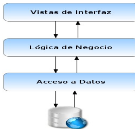
Ilustración 20: Arquitectura N Layer (3 Capas).
