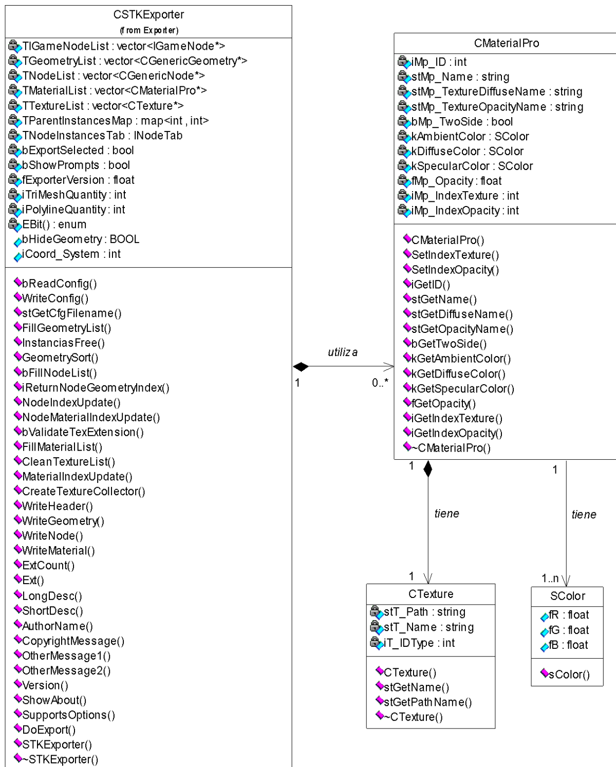
Fig 22: Diagrama de clases del paquete Material
