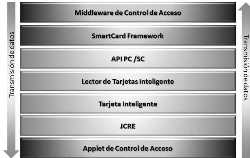
**Ilustración 14: Diagrama de capas de comunicación**
