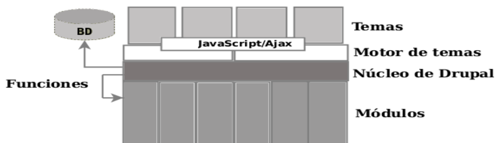
Figura 4. Estructura en capas del CMS Drupal. “(Cordero, 2009)”
