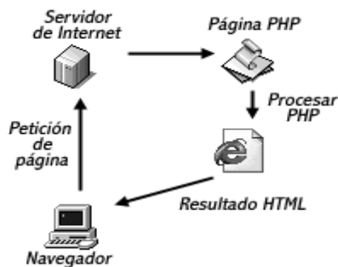
Figura 1.1 Esquema de representación del funcionamiento del PHP.
