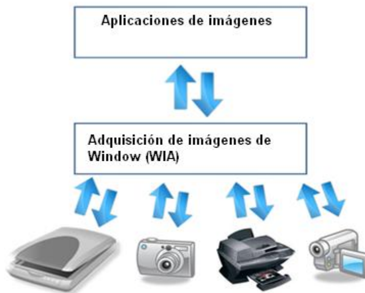
Figura 2. Gráfico que muestra la arquitectura básica de WIA como una vía de dos capas entre las aplicaciones de imágenes y dispositivos.
