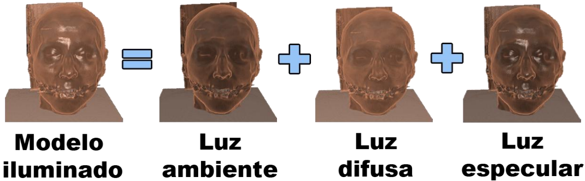
Fig. 17 El modelo de Phong está compuesto por tres componentes: la ambiente, la difusa y la especular.
