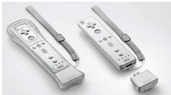
Figura 18. Wii Motion Plus conectado al Wiimote .
