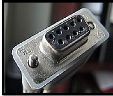
Figura: 6 Puerto Serie, Norma RS-232 DB-9
