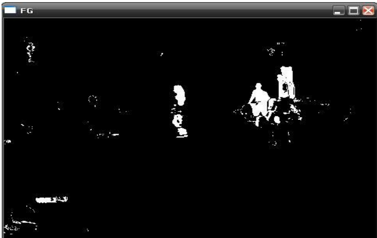
Figura 18: Video después de aplicarle la sustracción de fondo.
