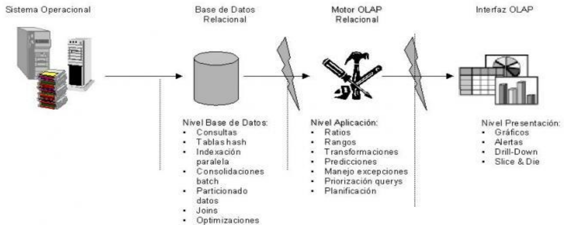
Figura 3: Arquitectura del sistema ROLAP
