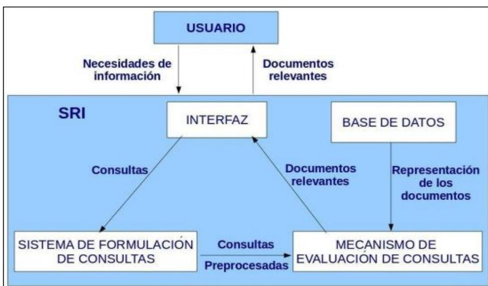
Figura2. Arquitectura de un Sistema de Recuperación de Información.
