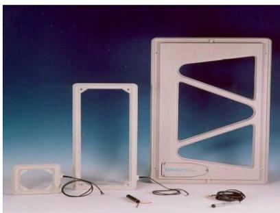
**Figura 5:** Distintos tipos de antenas de baja frecuencia. De pie: antenas de puerta; en el suelo: antenas de varilla.
