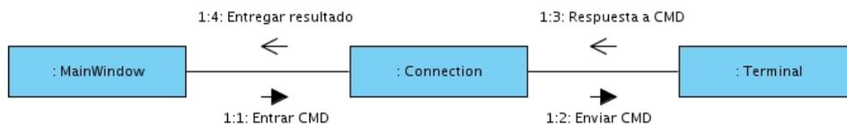
Figura 1.2: Diagrama UML de comunicación entre la interfaz gráfica de usuario de EIDMAT y GNU Octave.
