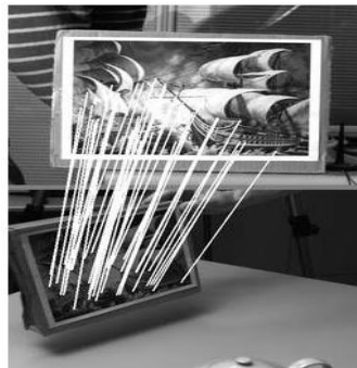
Figura 12: Bazar facilita el desarrollo de Realidad Aumentada basadas en la detección y correspondencia de rasgos naturales puntuales.
