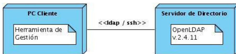
Figura 28: Diagrama de Despliegue del sistema
