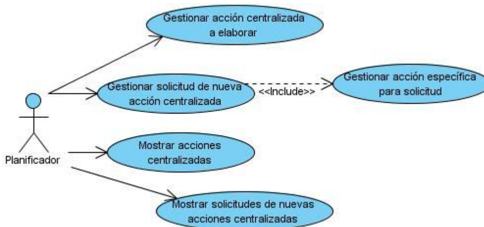
Figura 4 Diagrama de casos de uso del paquete “Planificación de Acciones Centralizadas y Solicitudes de nuevas AC”.
