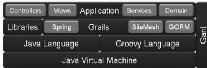
Figura 2: Arquitectura basada en Grails.
