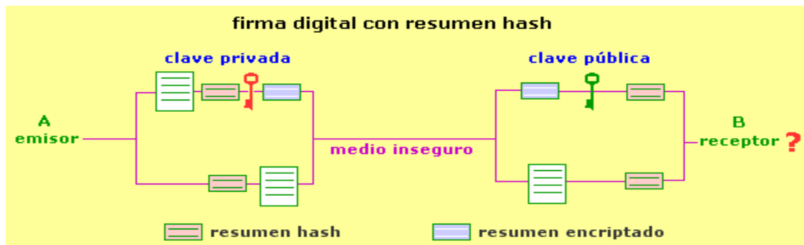
Figura 8. Esquema básico de una función de resumen hash.
