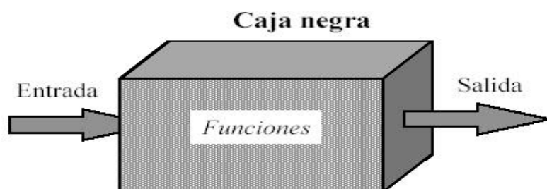
Figura 4.1 Enfoque de diseño de pruebas de caja negra.
