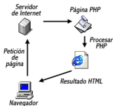
**Figura 2. Funcionamiento del PHP.**
