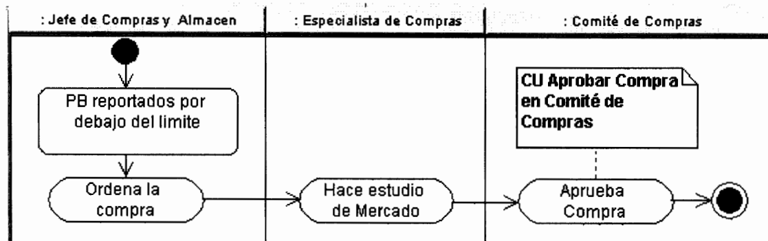
Figura 42: Diagrama de actividades para el caso de uso ordenar compra de productos básicos.
