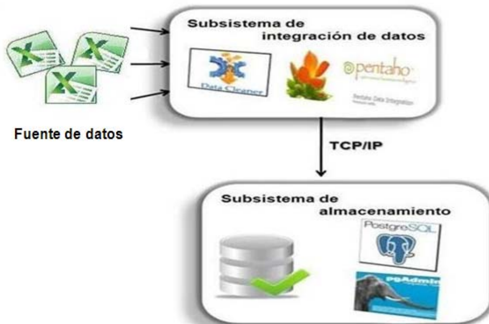
Fig 2. Arquitectura de los subsistemas de almacenamiento e integración del producto ACM 14F7
