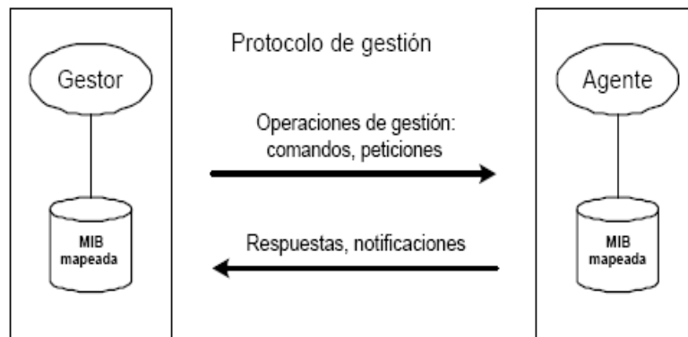
Figura 1: Arquitectura de un sistema de gestión SNMP.
