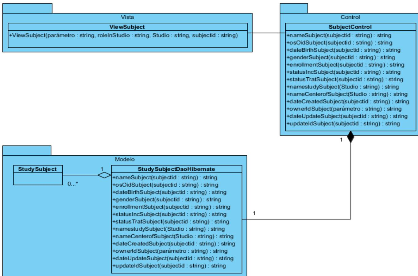
**Figura.16** Diagrama de clase de diseño CU Visualizar datos de sujeto
