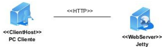
Figura 7: Diagrama de despliegue de la propuesta de solución
