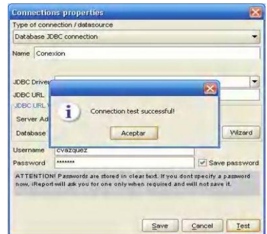
Figura 2. Comprobación de la conexión
