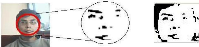
Figura 1.17: Extracción de características de una imagen tras tener previamente detectada el área del rostro (28).
