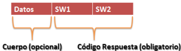
Figura 2: Respuesta con la cadena de datos a recibir y los bytes de Status Word .
