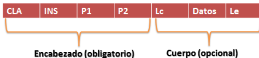
Figura 1: Estructura C- APDU.
