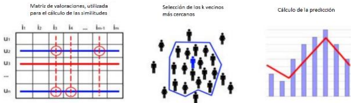
Figura 4. Proceso de recomendación en un sistema de filtrado colaborativo
