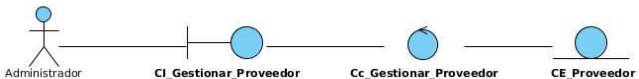
Ilustración 5. Diagrama de clase del análisis: CU Gestionar proveedores de datos.
