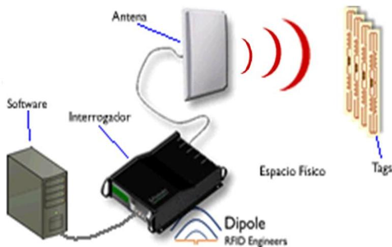
Figura 1: Funcionamiento de un sistema RFID.
