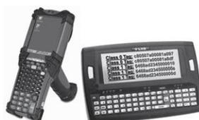
**Figura 10 Lector RFID móvil.**
